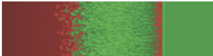
Кристаллизация за фронтом ударной волны от воздействия пикосекундного лазерного импульса в титане при лазерной ковке
