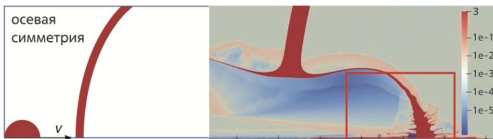
Моделирование пробития обшивки космического летательного аппарата. Разрушение обшивки с разным уровнем сеточной адаптации
