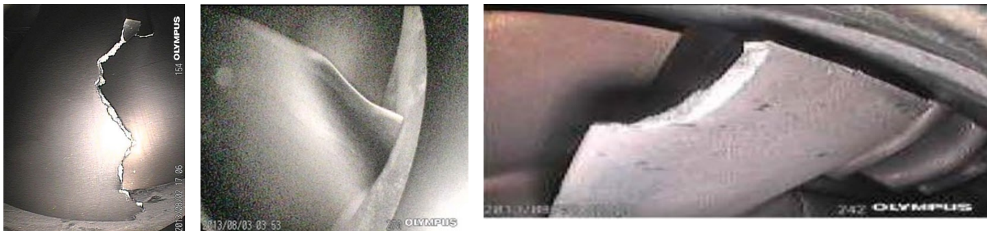
Повреждения лопаток компрессора двигателя
