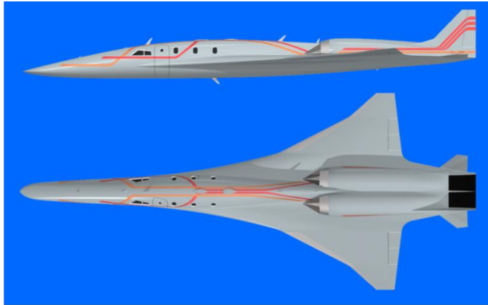
Схема легкого сверхзвукового делового самолета [1] с интегрированной с планером силовой установкой
