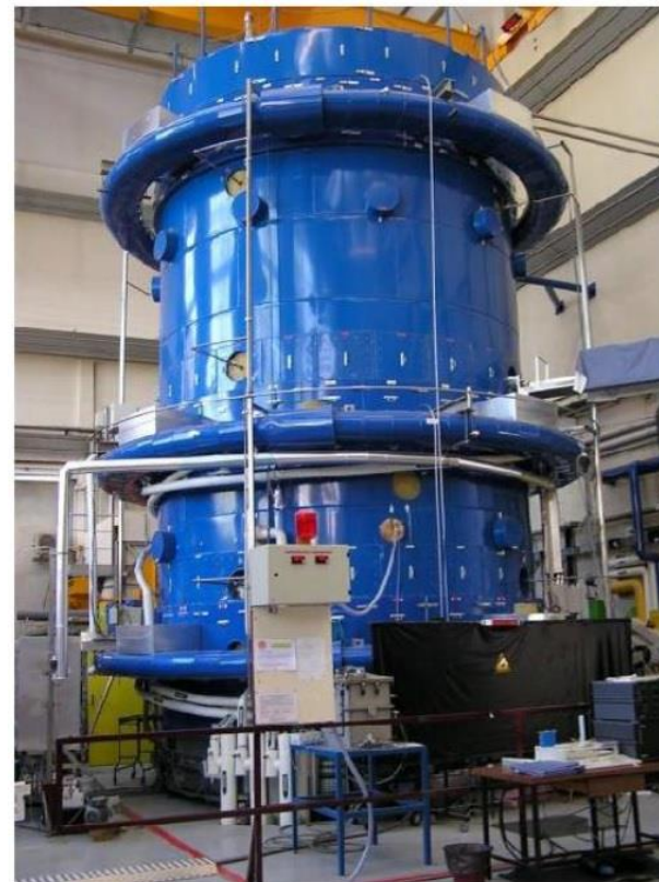
Экспериментальная установка MISTRA (CEA, Франция) Объем сосуда 97,6 м 3
