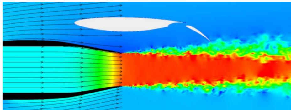
Использование вихре-разрешающих методов позволяет более точно выявить возможную интерференцию струи с элементами планера по сравнению с расчётами на базе уравнений Рейнольдса
